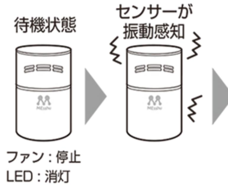
センサーが振動を感じ、自動プログラムによりファンが作動します。
