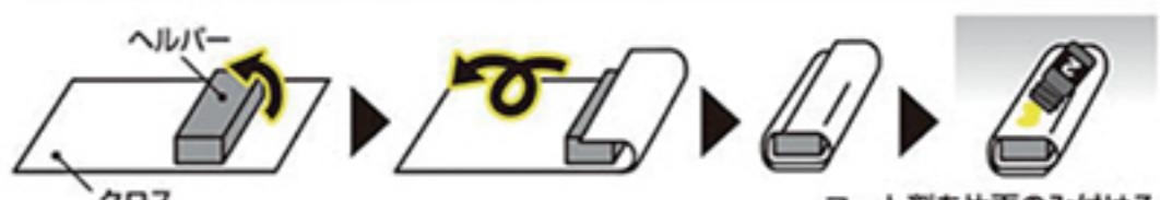
②コート剤を一定方向に、薄く均一に塗り広げて下さい。塗り跡が気になる場合は、乾いたクロス面で軽くならして仕上げて下さい。
