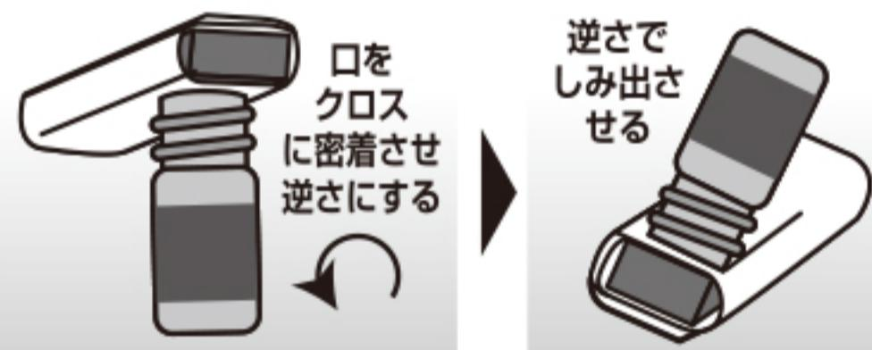
1. キャップを開け、口を上に向けたままクロスを巻いたヘルパー面に、ビンの口部を密着させ、そのまま斜め逆さまにし、コート剤をクロスに1cm程度しみ出させて下さい。
