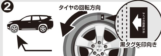
黒タグ矢印向きと、タイヤの回転方向が合うように本体を装着して下さい。
